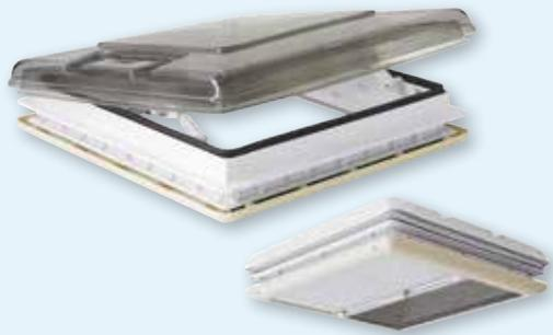
Lanterneau à aération permanente (150 cm<sup>2</sup>) à ouverture par compas automatiques (5 positions), avec Rollo Vent incluant moustiquaire et store occultant.
