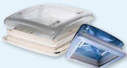
Grâce à la colonne d'air intégrée à son couvercle, ce lanterneau assure une entrée d'air permanente dans le véhicule sans utiliser de ventilateur. Ouverture multidirectionnelle par compas. Cadre intérieur coloris blanc RAL 9001 (crème) avec stores occultant et moustiquaire ajustables.
